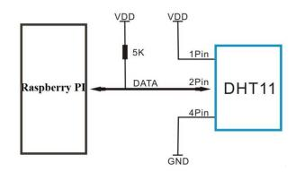
FIGURE 3. DHT11 circuit
